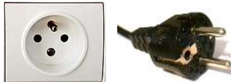
In diese Steckdosen passen zwar Schuko-Stecker, aber nur, wenn sie wie abgebildet ein Loch haben!
