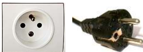
In diese Steckdosen passen zwar Schuko-Stecker, aber nur, wenn sie wie abgebildet ein Loch haben!
